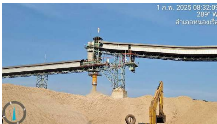
รูปที่ 2-11 ที่ครอบป้องกันฝุ่นฟุ้งกระจาย
